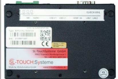
IQ-BOXPC-CORE Unterseite mit VESA 75x75 Befestigung und Gumminoppen
